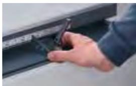
La escala de medición permite ajustar fácilmente el ancho del material según sea necesario.
